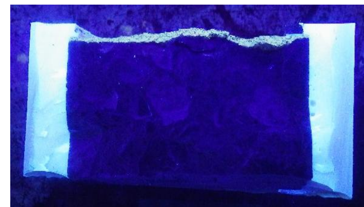
CAMシールNEOプラスの断面 【漏水なし】
