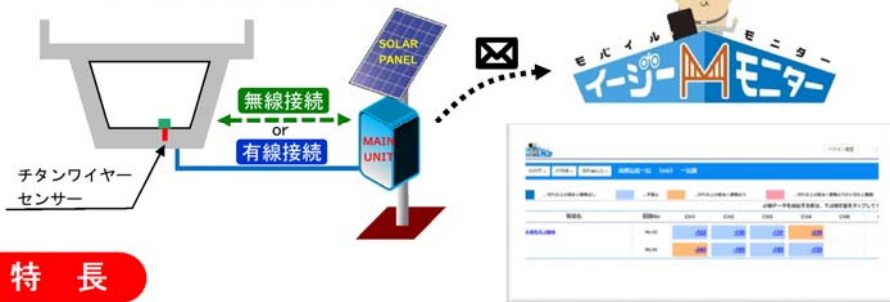
ASTMの腐食判定基準に応じた色分け表示
