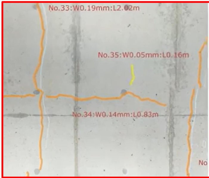
オルソ画像（正対展開図） + AIひびわれ解析
